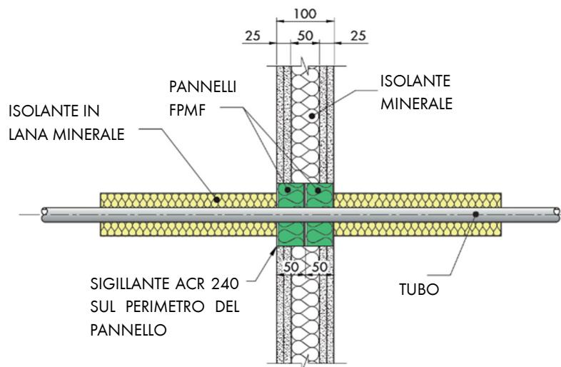
\* Isolamento di 600 mm di lunghezza min. richiesto per tubi in multistrato Alupex.
